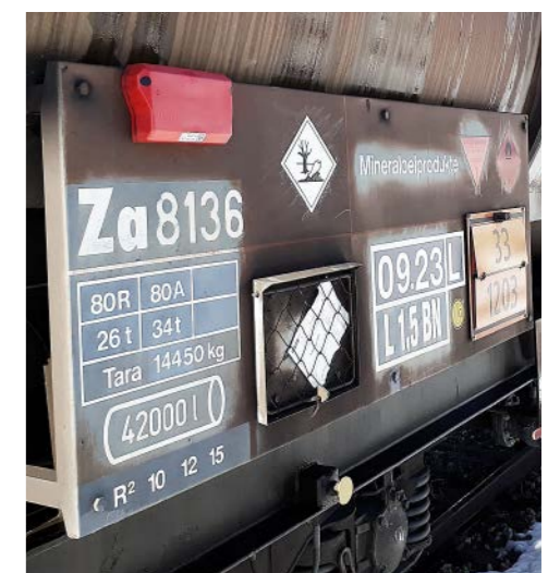
Die rote Telematik-Einheit beinhaltet Kommunikationsmodul, Batterie und ein Grundset von Sensoren (siehe nächster Abschnitt).
